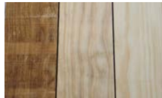
VERFÄRBUNG: ROHES BRETT, NACH DER OBERFLÄCHENBEHANDLUNG 3 MM UND NACH DER OBERFLÄCHENBEHANDLUNG 6MM VOM ROHLING
